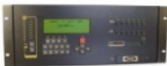
bells8 è il programmatore elettronico campane di nuova generazione con display grafico per gestire da 1 a 88 uscite per il comando di campane, orologi da torre, impianti di riscaldamento, illuminazione, ecc, disponibile in set da 4, 8, 16 e 32 uscite e nella versione Progres fino ad 88 uscite.
